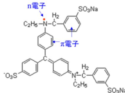
図-1 ライトグリーンイエローの化学構造と電子
