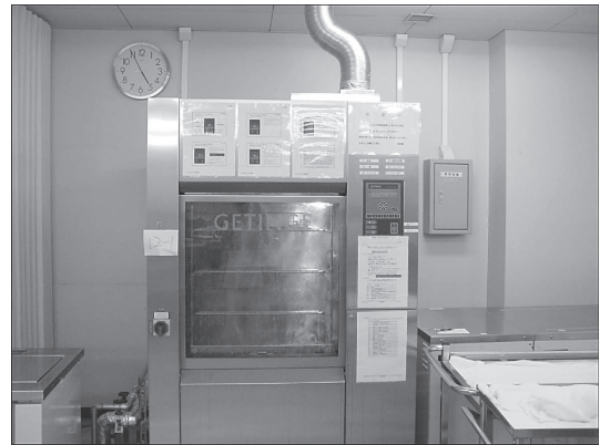
図15. ウォッシャーデイスインフェクター。中央材料部に装備してある。
